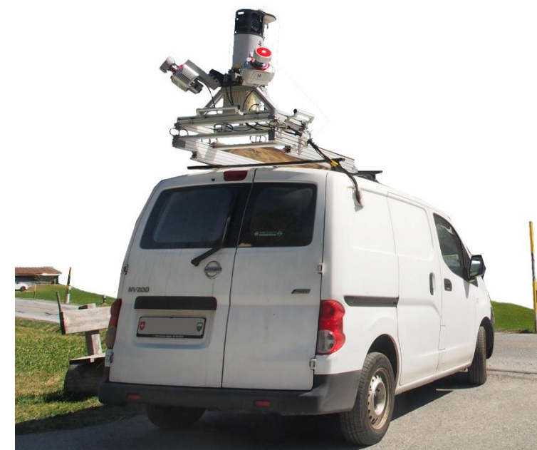
Véhicule utilisé pour le relevé LiDAR mobile [source Helimap]
