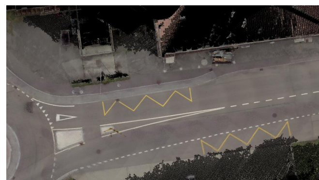
Orthophoto de résolution 3cm générée à partir des points
