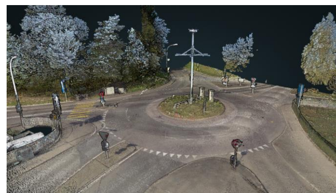
Nuage de points avec filtrage algorithmique des objets mobiles
