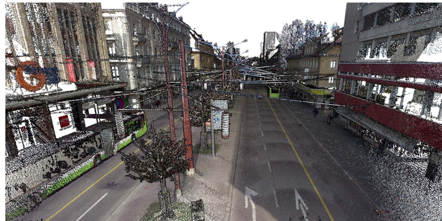
Nuage de points avec filtrage algorithmique des objets mobiles
