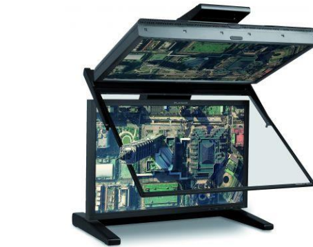
Station photogrammétrique utilisée pour la saisie 3D des bâtiments
