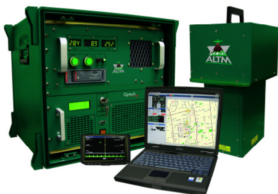
Figure 2: Les composantes du système LIDAR Optech ALTM Gemini
